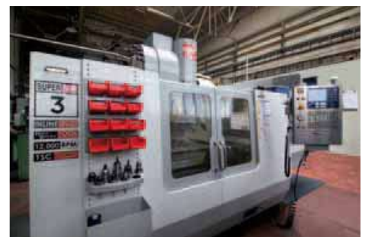
CNC processing centre HAAS Super VF 3
